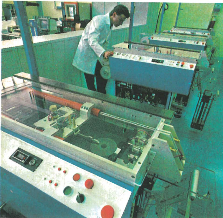
Dopo la lucidatura del disco un'apposita macchina operante in ambiente sterile provvede all'inserimento dello stesso nel suo Jacket.
