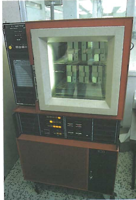
Nelle celle climatiche di prova la temperatura di condizionamento arriva a 53° (i range di temperatura per un corretto funzionamento vanno da 4° C a 53° C).
