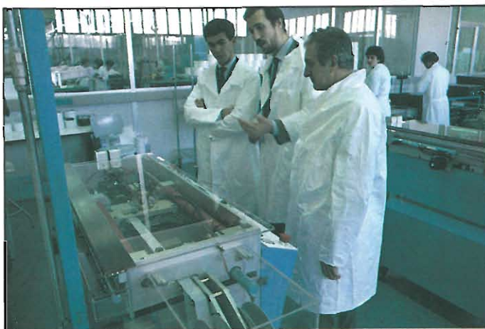
Nelle camere bianche la percentuale di polvere nell'aria è controllata da sensori sofisticati in modo da garantire un più alto livello qualitativo dei dischi.
